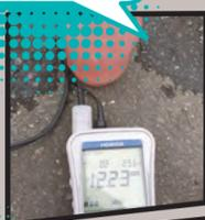
2 稽查員立即採集水樣進行測試，以水質簡易包初步分析廢水特性
