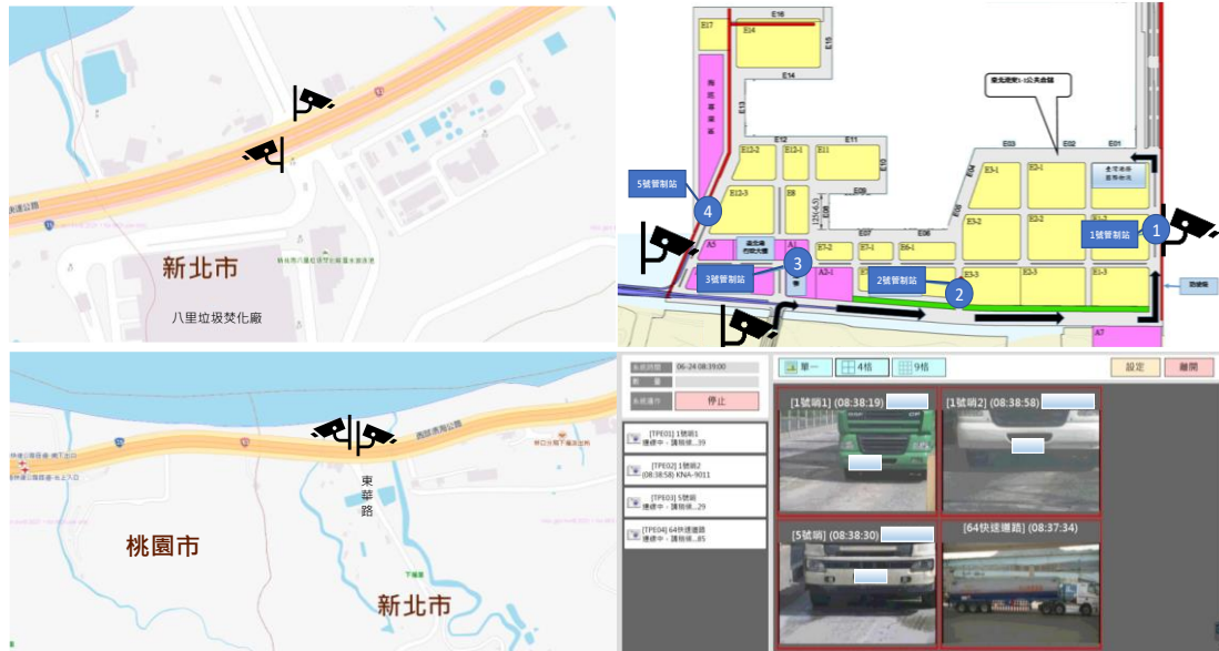
圖一、西濱海岸空氣品質維護區車牌辨識架設置位置與擷取畫面
